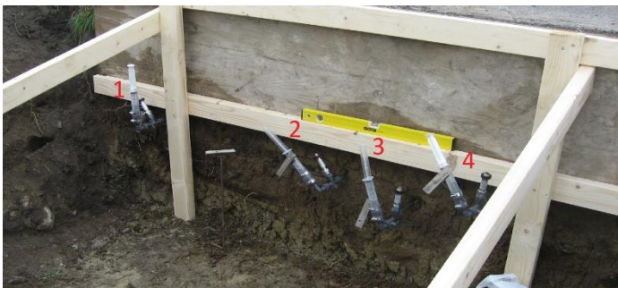
Figur 32. Foto af jordtryksmålere og skematisk visning af placeringer under vejoverflade.
