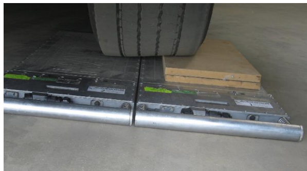
Figur 7. Foto af kantforsøg for venstre forhjul på sættevognstrækkeren for sættevognsvogntoget. Her vist forsøg med en kvart del af hjulet på kanten
